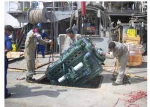
Um dos três geradores a diesel que fornecem suprimento elétrico a bordo no USNS Catawba.
