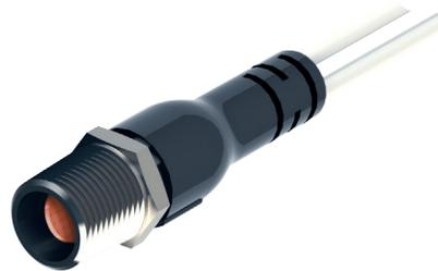
O sensor de temperatura Série TM-950 incorpora uma técnica de vidro fundido exclusiva para produzir uma caixa hermeticamente vedada. O vidro fundido é colocado dentro da caixa aquecida. Quando o conjunto esfria, a caixa de metal se contrai, comprimindo o vidro. Além disso, a superfície entre o metal aquecido e o vidro se funde no nível molecular. Dois tubos de aço niquelados são posicionados antes do processo de fundição do vidro, a fim de deixar uma passagem para as
